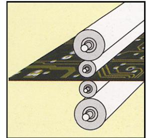
一般にガラス基板や電子基板のクリーニング装置には、クッションと吸着性があるシリコンゴムローラーを使用します。さらにゴムローラーと本製品を接触させることで、ゴムローラー表面に堆積したゴミを粘着シートに転写して取り除きます。
